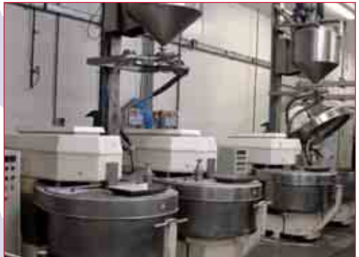
Vier Knetter versorgen die Muffinlinien mit Massen.
