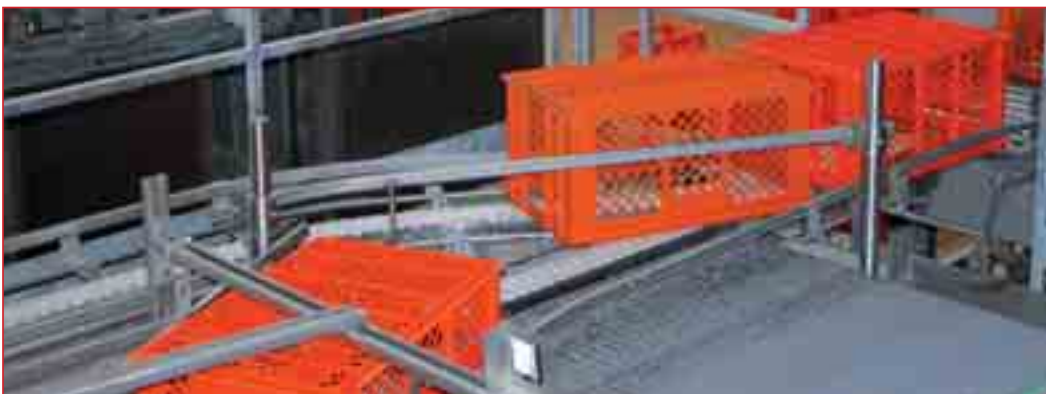
Eine Auslaufweiche aus der Waschanlage sortiert die Kästen.
