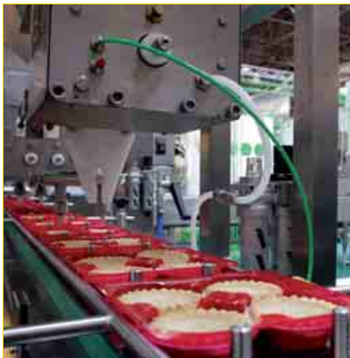
Auf der diesjährigen interpack Processes and Packaging zu sehen: eine Dosieranlage zum Befüllen von Torten und Feinen Backwaren.
