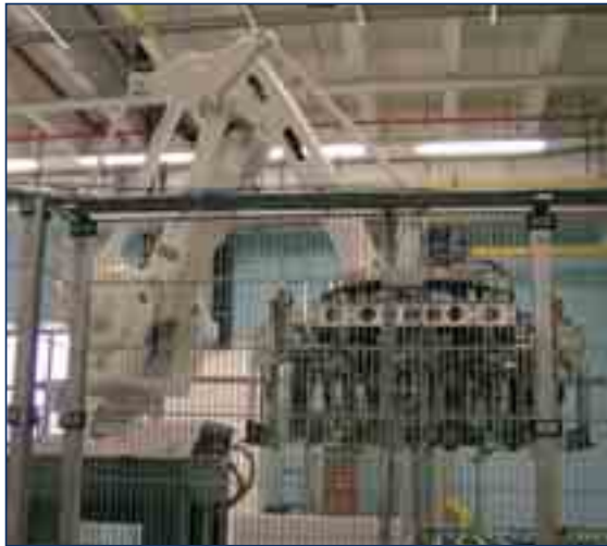
Vollautomatischer Palettierer von Komatec für die zwei TK Brötchenlinien.
