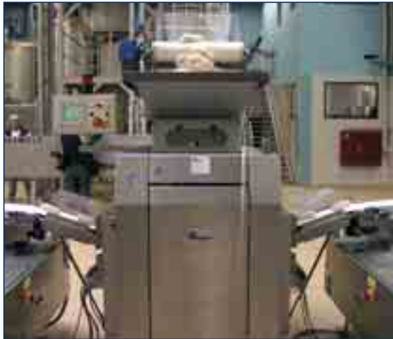
Die Teigformung für die TK-Brötchenproduktion auf den Megalines übernimmt ein Dough-Master von Benier.
