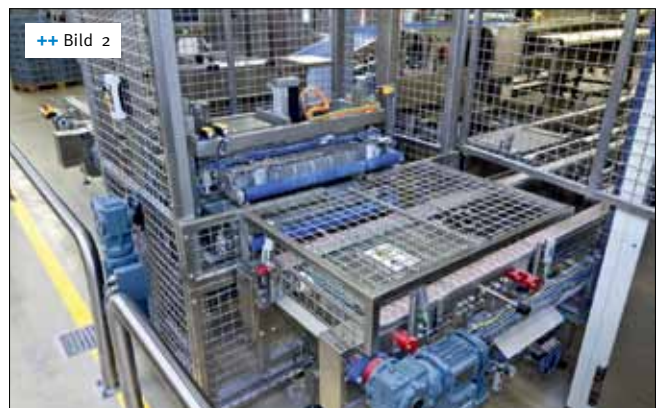
++ Bild 2 Die Peelboard-Wendemaschine dreht von nach unten gewandtem Gären zu nach oben gewandtem Backen automatisch und rezeptkontrolliert
