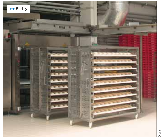
++ Bild 5 ... der Ofenbelader Athlet übernimmt, nachdem die Wagen angedockt sind
