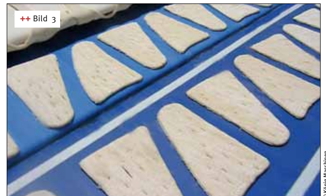
++ Bild 3 Die Produktion von Sangak – einem traditionellen iranischen Flachbrot/Fladenbrot
