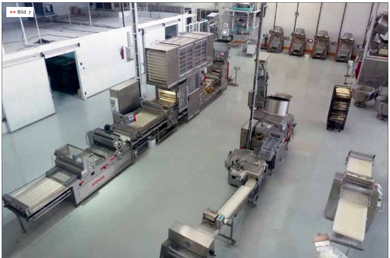
++ Bild 7 Die König Brötchenlinie CombiLine und die Brotlinie Ceres sind Teile der Teigauflageeinheiten
