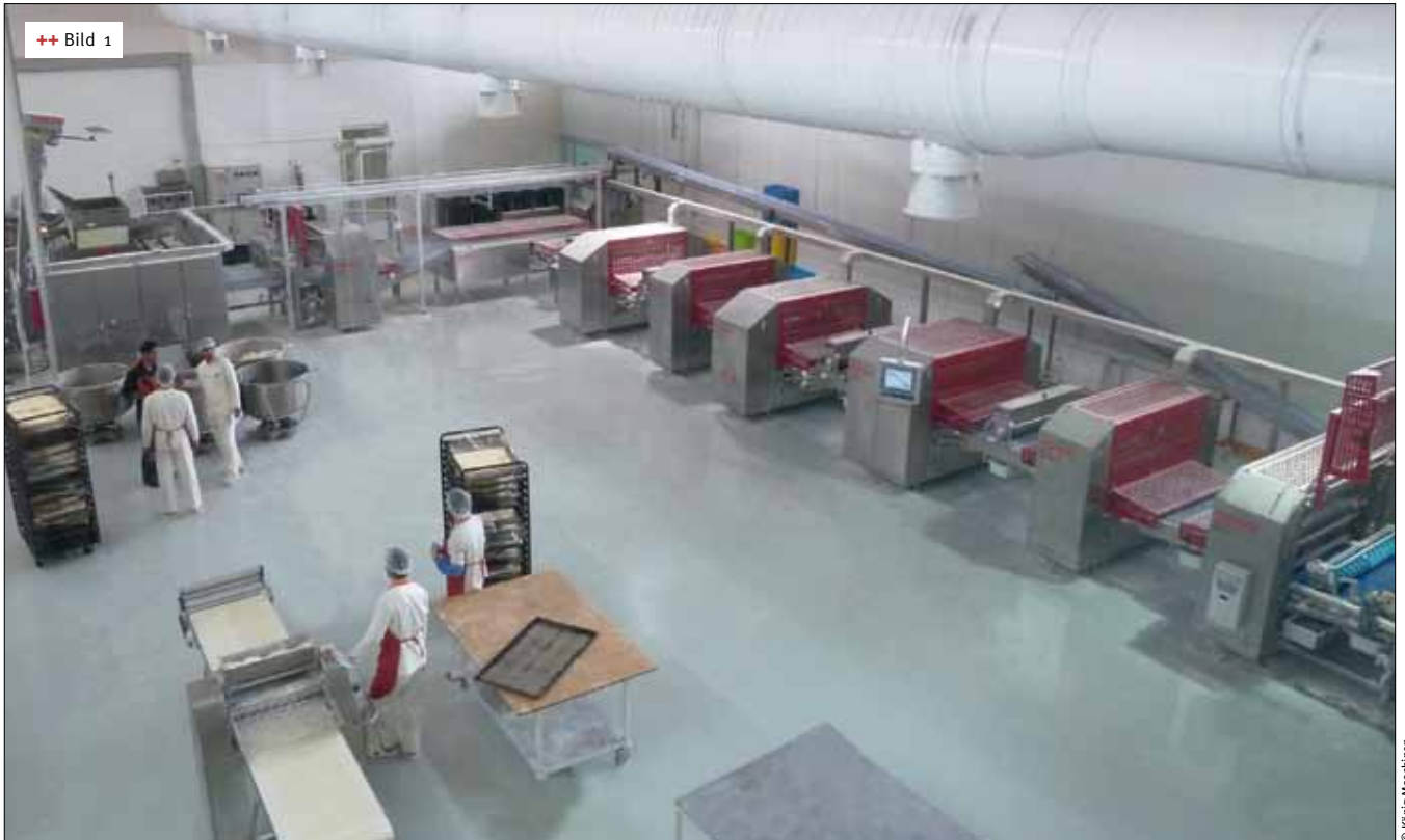
++ Bild 1 Herstellung von Baguettes auf der Menes Laminieranlage von König
