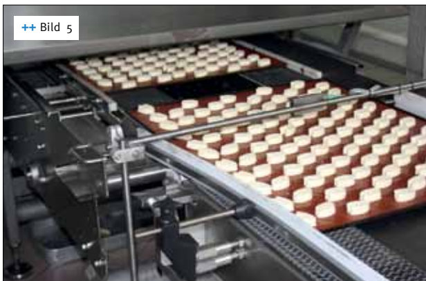
++ Bild 5 Nach dem Schneiden landen die Schweineohren auf Blechen
