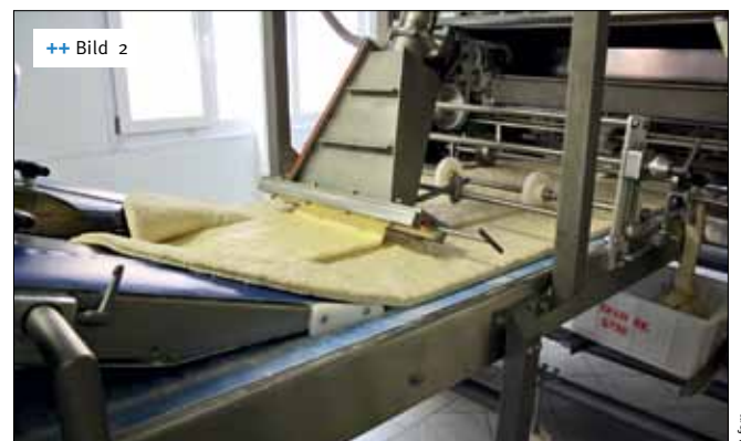
++ Bild 2 Das Fett wird kontinuierlich in den Teig eingearbeitet
