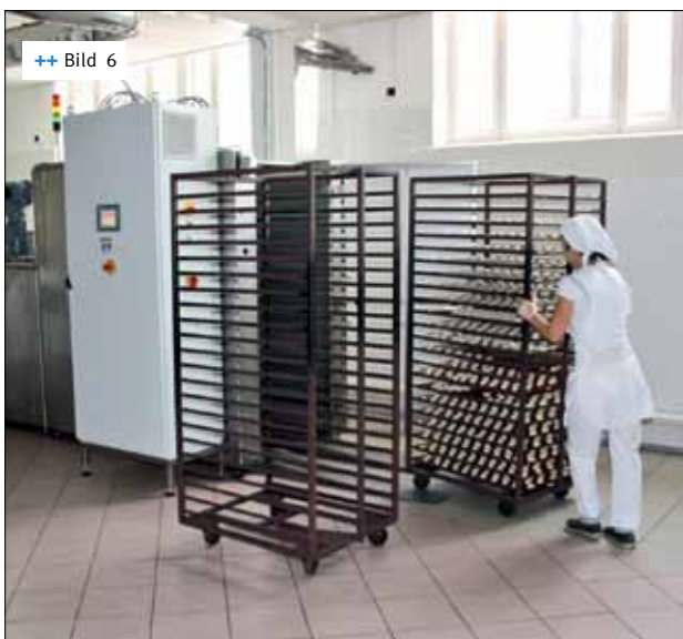
++ Bild 6 Das Befüllen des Stikkenwagenbeschickers
