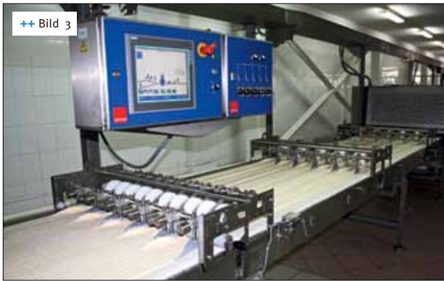
++ Bild 3 In drei Stufen werden die Schweineohren gefaltet
