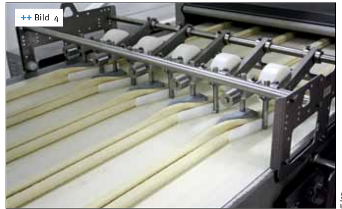
++ Bild 4 Kunststoff-Schienen sorgen für die Form
