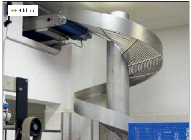
++ Bild 10 ... dieses trägt die Brote in Deckenhöhe in den Nebenraum zum Verpacken
