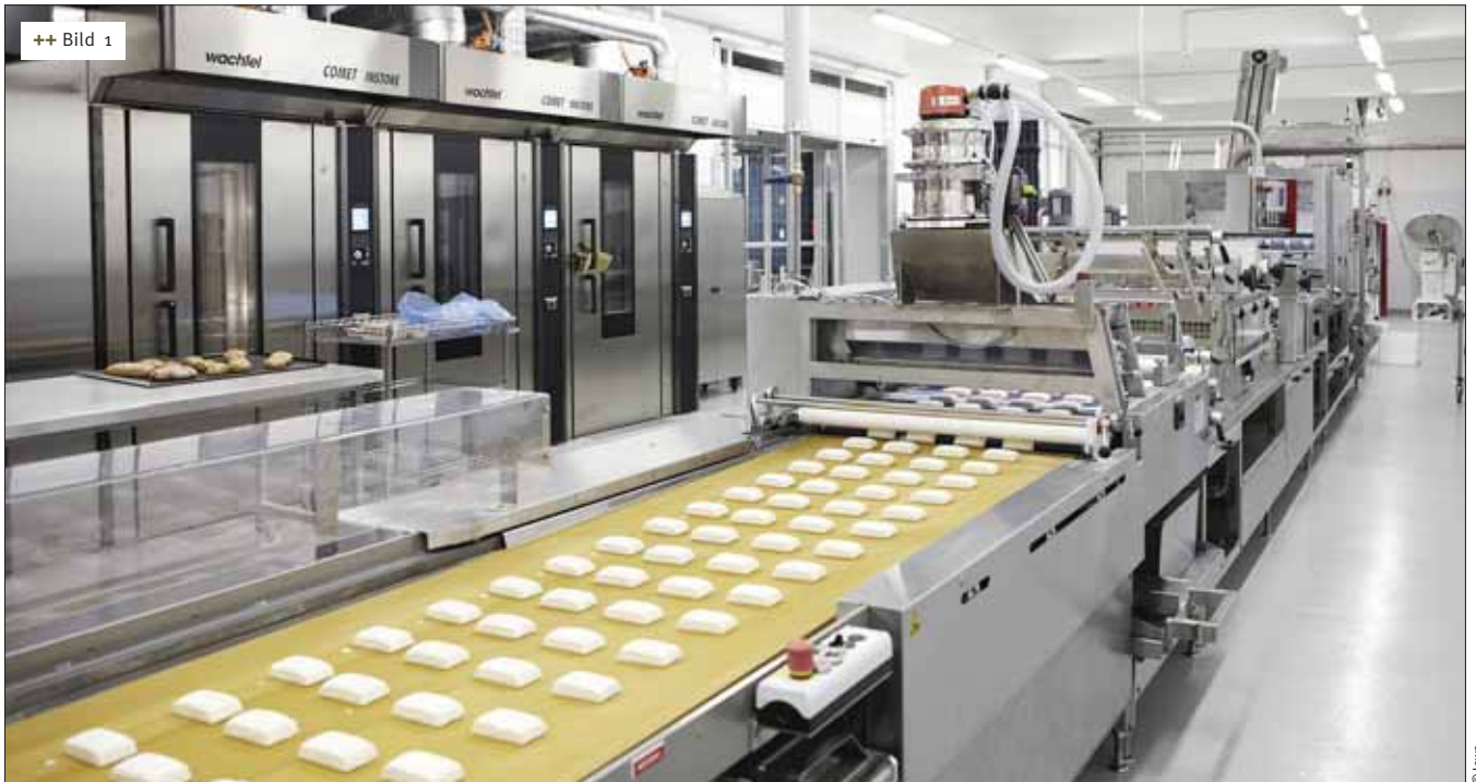
++ Bild 1 Die Teigbandanlage wurde modifiziert, damit der Teig schonend ausgerollt werden kann
