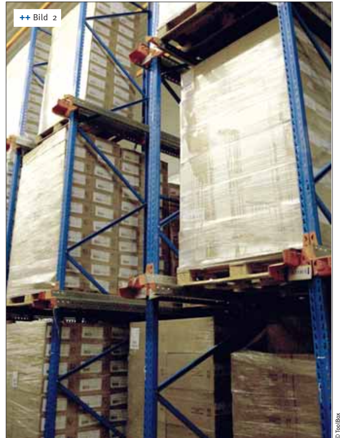
++ Bild 2 Paletten TK-Hochregallager im TK-Bereich inkl. Stellplatzbezeichnung
