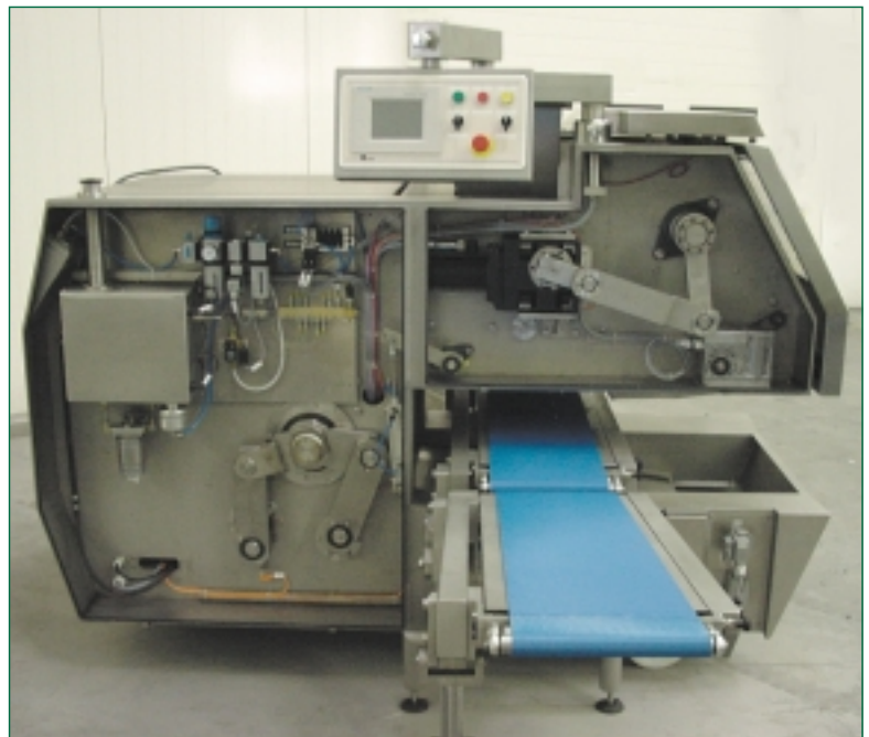
<< Die Übergabebänder des Dough Masters werden alle separat angetrieben und mit der aktuellen Leistung synchronisiert.
