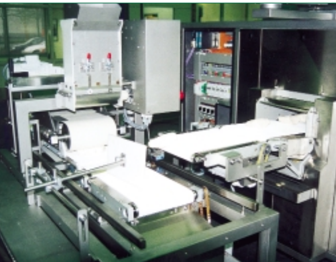
^ Die Saugkolben, immerhin 20 kg schwer, lassen sich zur Reinigung rausklappen.
