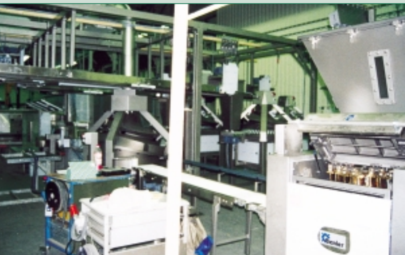
Die große Anlage zur Herstellung von Rundbrot, gebaut für eine amerikanische Großbäckerei, wird in den Werkshallen von Benier komplett zum Test aufgebaut.
