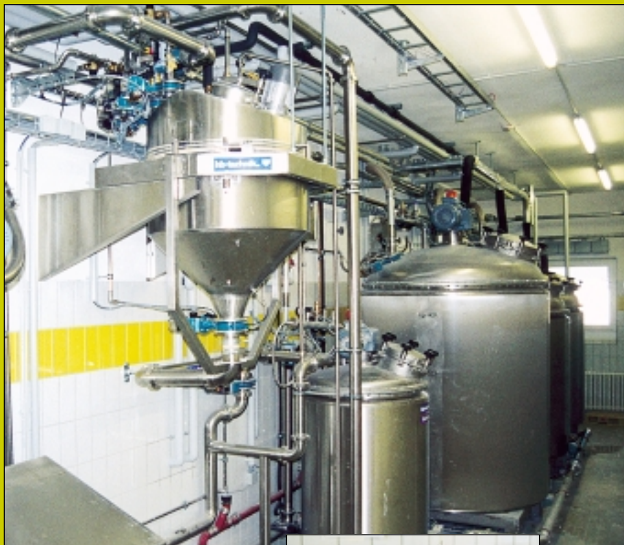
Flüssigkomponenten- und Sauerteiganlage „Europro“ aus zwei Roggensaueranlagen à 2.500 l und einer Weizensaueranlage mit 3.000 l.
