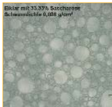
Bild 1: Eiklar/Zucker-Schaum mit 33 % Saccharose; Maßstabskala 200 µm
