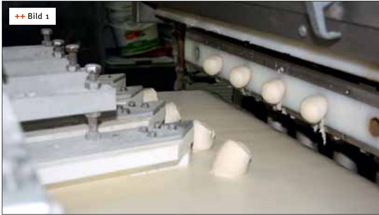
++ Bild 1 Der Teig für die Hamburger-Brötchen wird in vier Reihen extrudiert und kommt dann zum Ruhen in Tröge
