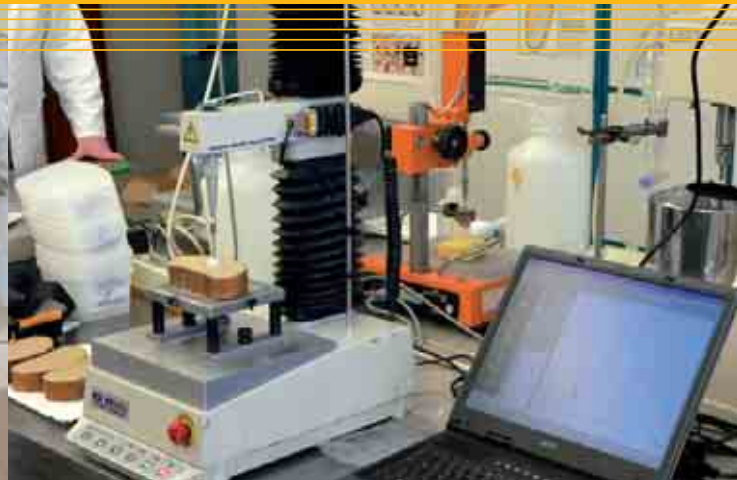
Penetrometermessungen sorgen für objektive Daten.
