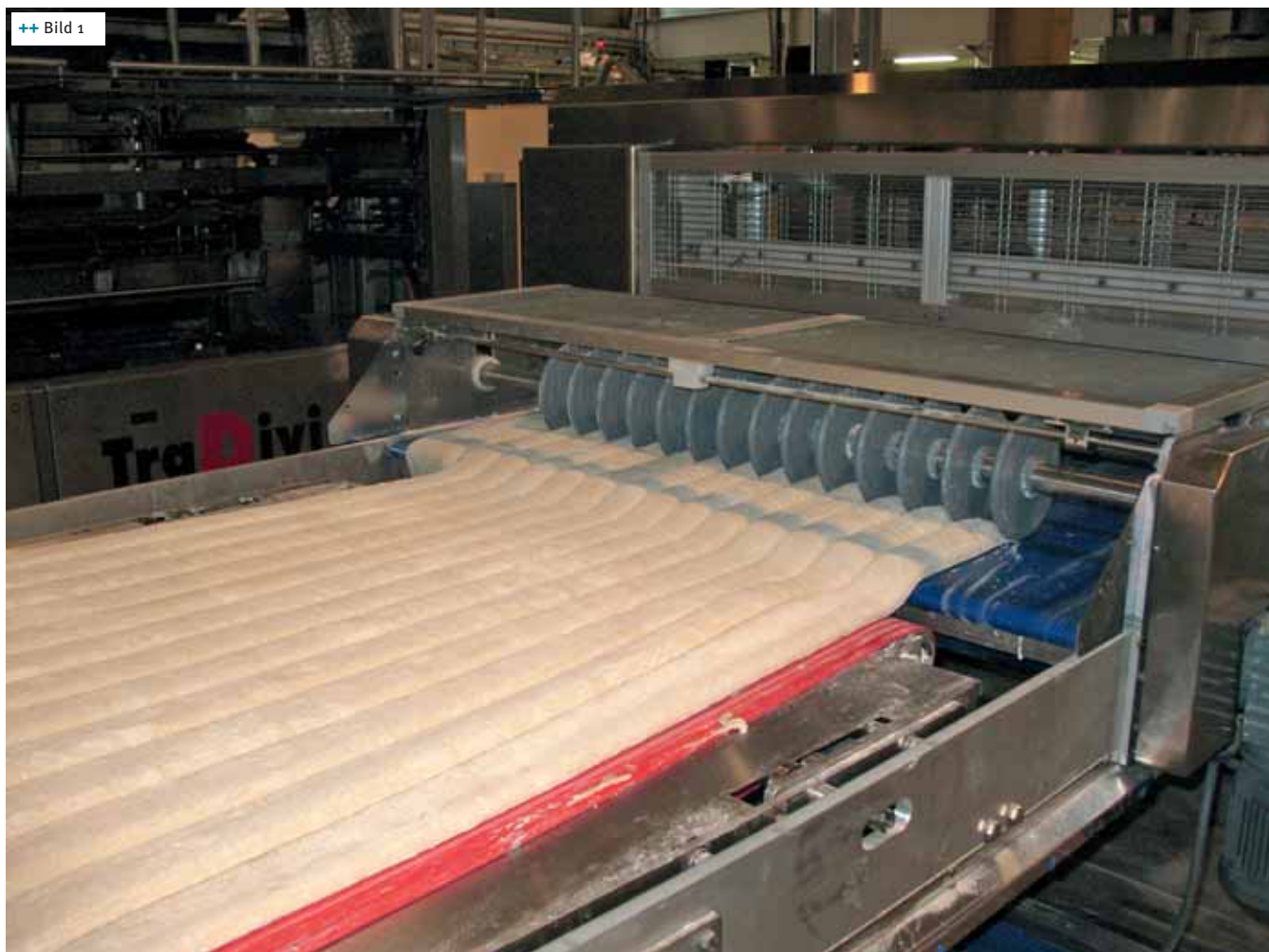
++ Bild 1 Das Teigband läuft vor dem Schneiden lediglich durch ein Satellitenwerk und einen Kalibrierkopf und behält so weitgehend die Teigstruktur.
