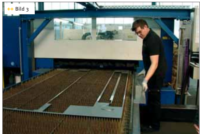
++ Bild 3 Vollautomatischer Blechzuschnitt per Laser, anschließend händisches Ausstanzen
