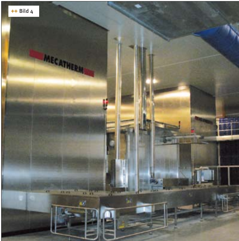
++ Bild 4 Gären, Backen, Kühlen – dafür ist auf beiden Linien Mecatherm zuständig
