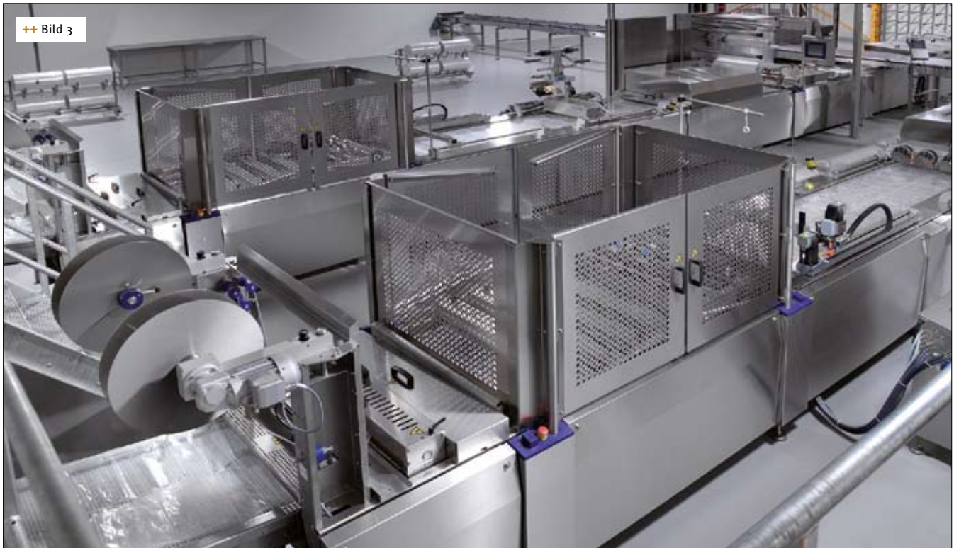
++ Bild 3 Die Brötchen werden vollautomatisch in Tiefziehfolien verpackt
