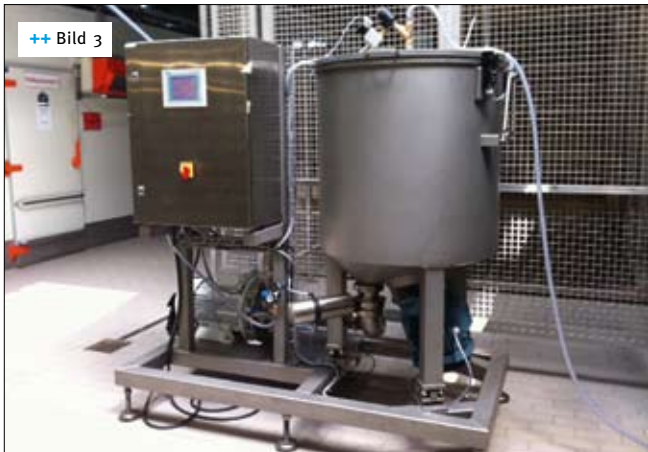
++ Bild 3 Der Feinstzerkleinerer verbraucht einen Platz von 2 m 2
