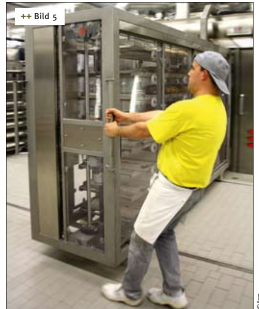
++ Bild 4 + 5 Der Lader wird bei Moss manuell an den Öfen querverfahren. Der komplette Ofenbereich mit den zehn Thermo-Roll-Öfen ist ca. 15 m lang
