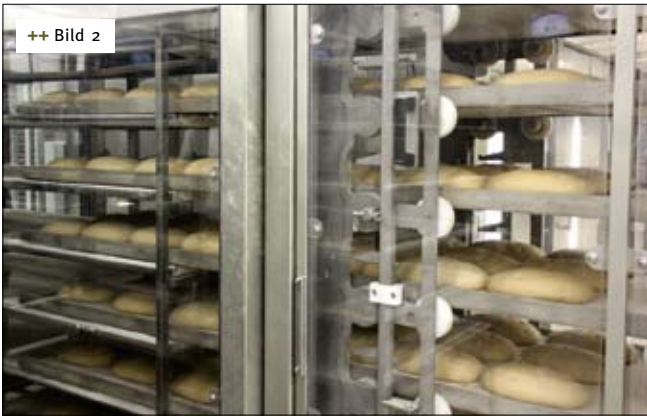
++ Bild 2 Der Lader schiebt von rechts seine acht Zungen in die Dockingstation und nimmt beim Zurückziehen die Brote mit
