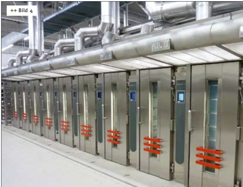
++ Bild 4 + 5 Der Lader wird bei Moss manuell an den Öfen querverfahren. Der komplette Ofenbereich mit den zehn Thermo-Roll-Öfen ist ca. 15 m lang
