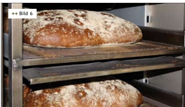
++ Bild 6 Das Winzerbrot liegt direkt auf der Steinplatte des Thermo-Roll-Wagens im Ofen; die Heizplatte darunter überträgt die Wärme des Öls
