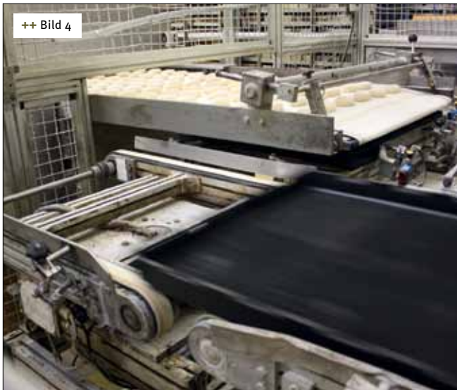
++ Bild 4 Über das Schienensystem (rechts im Bild) gelangt die Diele auf die drehbare Übergabestation und von hier weiter unter das Brötchenförderband
