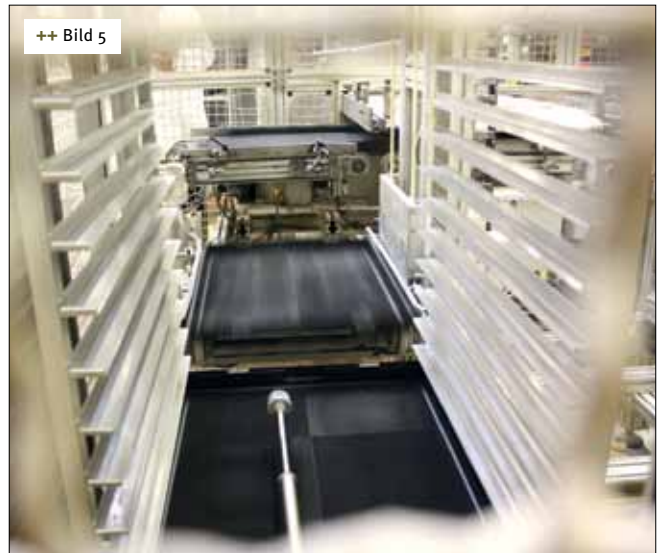
++ Bild 5 Der Schieber „katapultiert“ die Diele auf das Schienensystem
