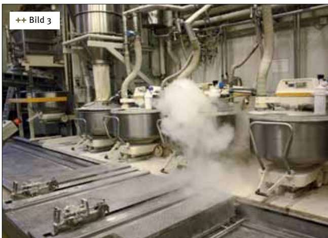
++ Bild 3 Die Knetstation bei Brinker arbeitet mit CO 2 zur Teigkühlung
