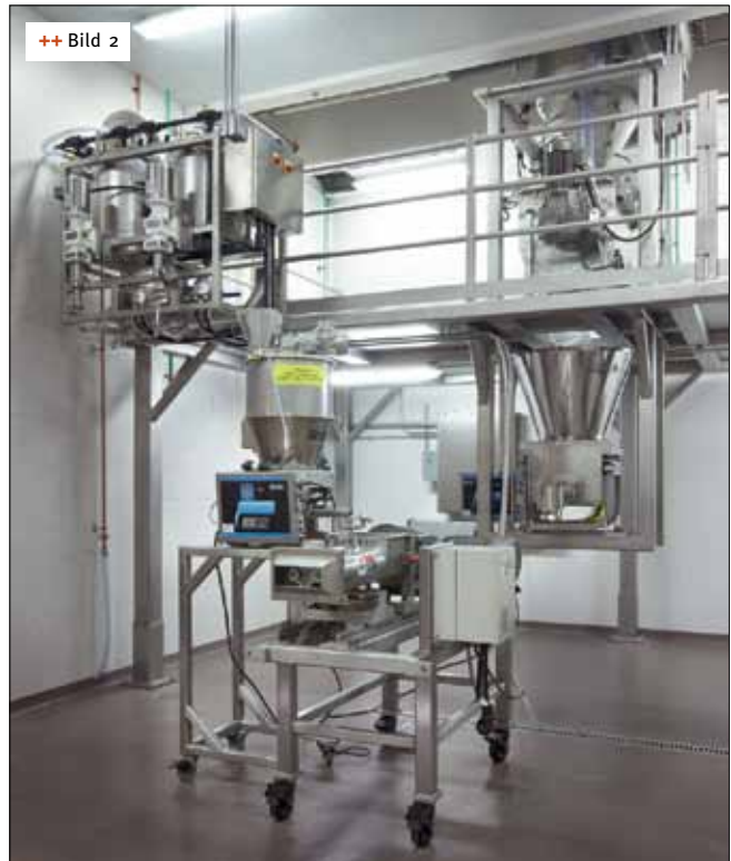
++ Bild 2 Die Rohstoffbereitstellung für den neuen Kneiter. Stücker Bestandteile oder Sauer- teige lassen sich wie die anderen Rohstoffe automatisch dosieren
