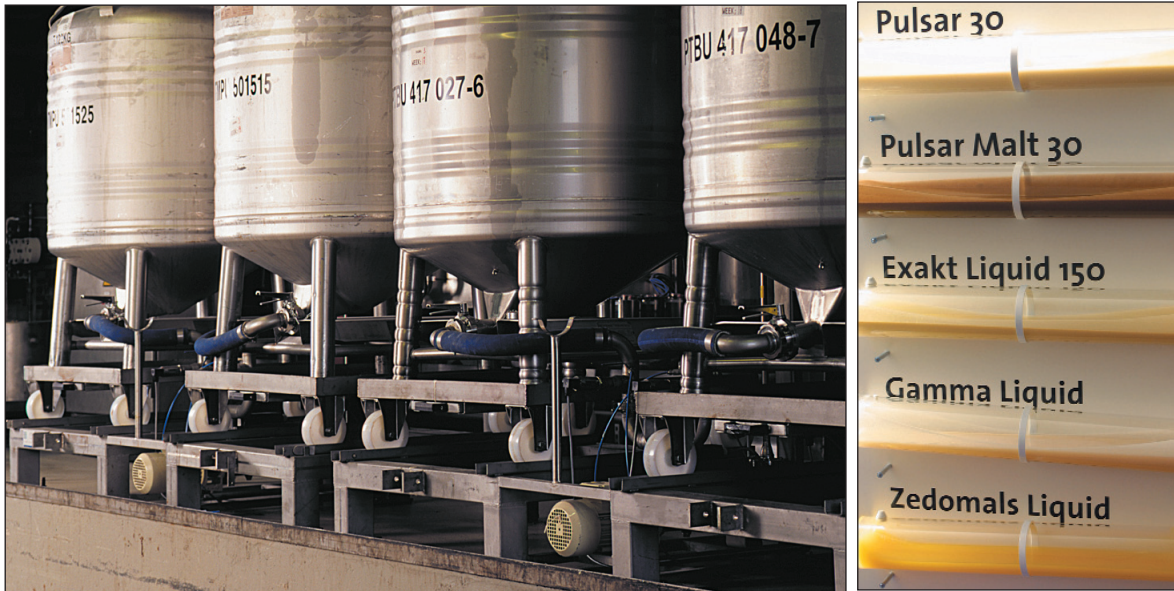
Linkes Bild: Die Backmittel werden in Containern zu 400 und 800 l geliefert.
