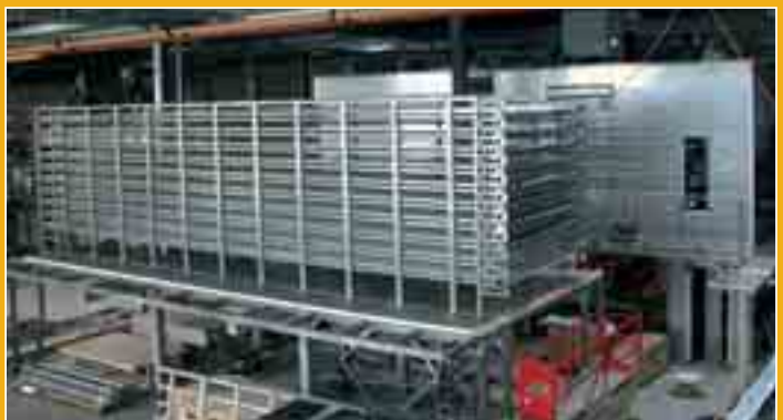
Der Bändergärschrank einer der beiden Brotlinien.
