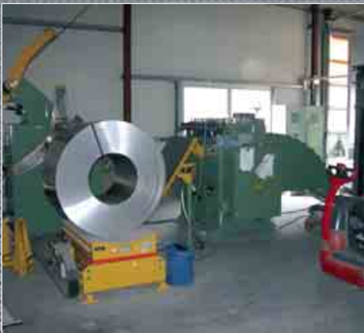
Das Aluminiumblech wird auf großen Rollen angeliefert und maschinell zugeschnitten geformt und beschichtet.
