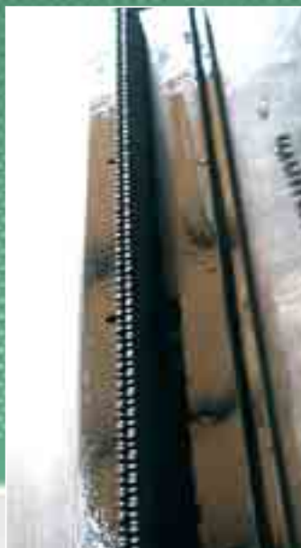
Die „Nadeln“ stechen die Löcher in die Bleche.
