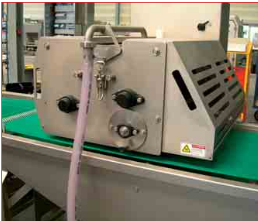
Bis zu 12.000 Minipizzen lassen sich mit der neuen Anlagen mit Soßekleksen dekorieren.
