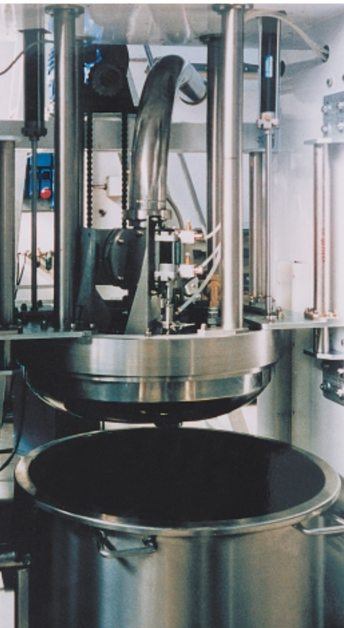
Ein Stempel, der in den Aufschlagkessel abgesenkt wird, sorgt dafür, dass die Masse schonend durch das mittige Rohr aus dem Kessel befördert wird.
