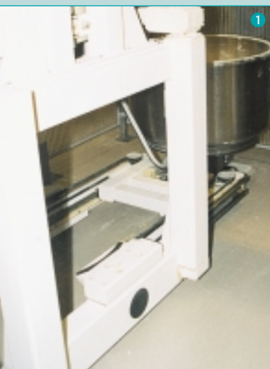
1 Das Lineartransportsystem zieht eine Schale ein, hebt sie und transportiert sie zum nächsten Arbeitsschritt.
