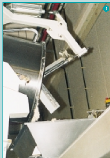
3 Um eine restlose Entleerung der Knetschalen zu sichern, ist eine Ausschälvorrichtung am Hebekipper montiert.
