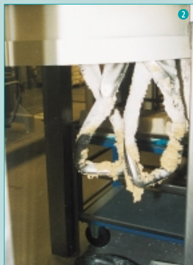
2 Die Knetwendel nach dem zweiten Knetvorgang zeigen die Konsistenz der fertigen Waffelmasse an. Durch den permanenten Betrieb und die Monoproduktoorientierung ist eine zwischenzeitliche Reinigung nicht nötig.
