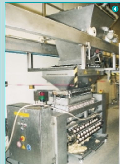
4 Nach dem Ausschälen liegt der Teig in einem fahrbaren Vorportioniertrichter, der zwischen den beiden Kopfmaschinen pendelt und so die permanente Produktion ermöglicht.
