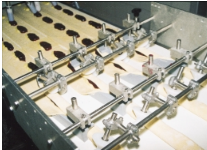
Zwei Füllstationen tragen Vanillekrem und Kirschfüllung auf. Die gefüllten Teigbänder werden mit Faltschuhen geschlossen und anschließend geteilt.
