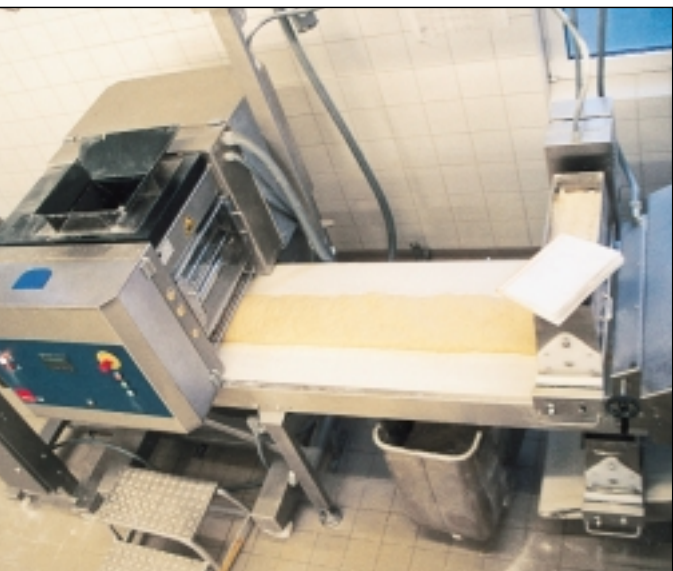
Der Teigbandformer wird manuell befüllt, denkbar ist aber auch eine Lösung mit Hebekipper und Vorportionierer.
