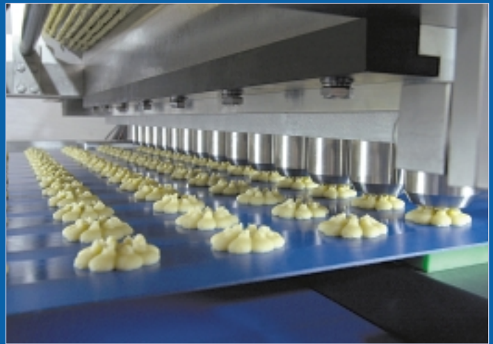
Beim Einsatz einer Zahnradpumpe beträgt die minimale Dosiermenge pro Reihe 4 g. Die Dosierlänge ist über die Taktzahl variabel regulierbar. Beispielsweise beträgt sie bei 40 Takten 100 mm oder bei 60 Takten 20 mm.
