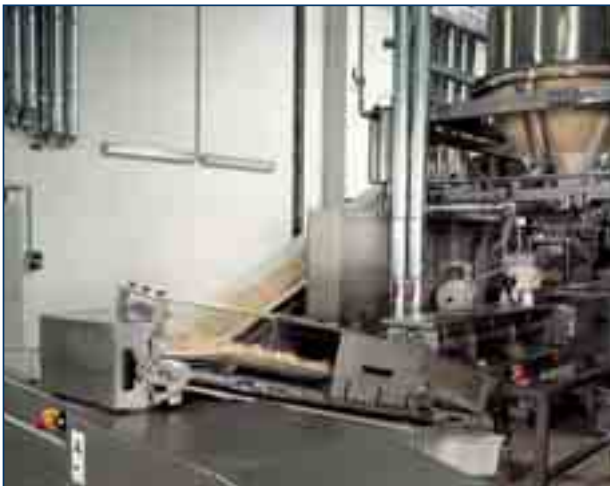
Teigbereitung in zwei Phasen mit dem Codos-System: Unter dem Dosierbehälter mischt ein Codos-Knetter die Zutaten, fördert sie in einen zweiten Knetter, wo die eigentliche Teigbereitung stattfindet. Im Hintergrund läuft der fertige Teig über ein Transport- und Ruheband zur Aufarbeitung.
