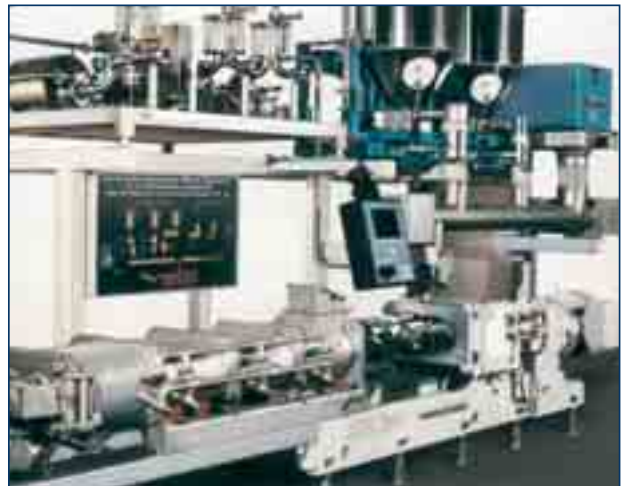
Der ZPM-Knetter von WP-I im halbgeöffneten Zustand. Die Gleichdrallschnecken sorgen für die Teigbildung und gleichzeitig für den Produkttransport im System.
