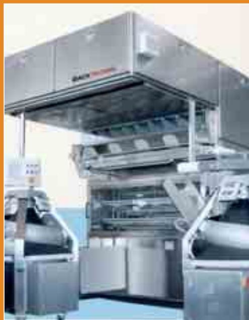
Die klassische Konfiguration einer Brotanlage, hier am Beispiel von Backtechnik S.I.: Teigteiler, Zwischengärschrank und Langroller. Im industriellen Maßstab funktioniert das meist in gleicher Konstellation, nur mit entsprechend größeren Anlagen.
