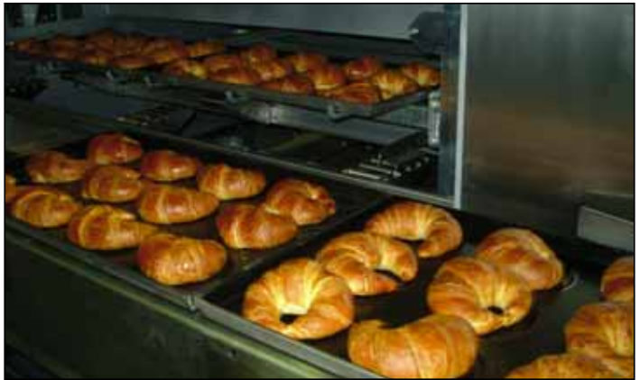
Das neueste Modell aus der Reihe der Serpentine-Öfen von Auto-Bake hat ein besonderes Transportsystem für Bleche, die alle möglichen Größen haben können, d.h. die verwendeten Backbleche sind unabhängig vom Ofensystem.
