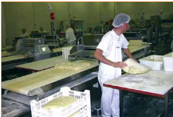
Nach der Ruhezeit bringen Ausrollmaschinen die Teigballen auf die richtige Stärke.
