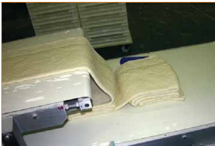
Der Pogac-Teig wird laminiert und wandert dann in einen gekühlten Ruheraum.
