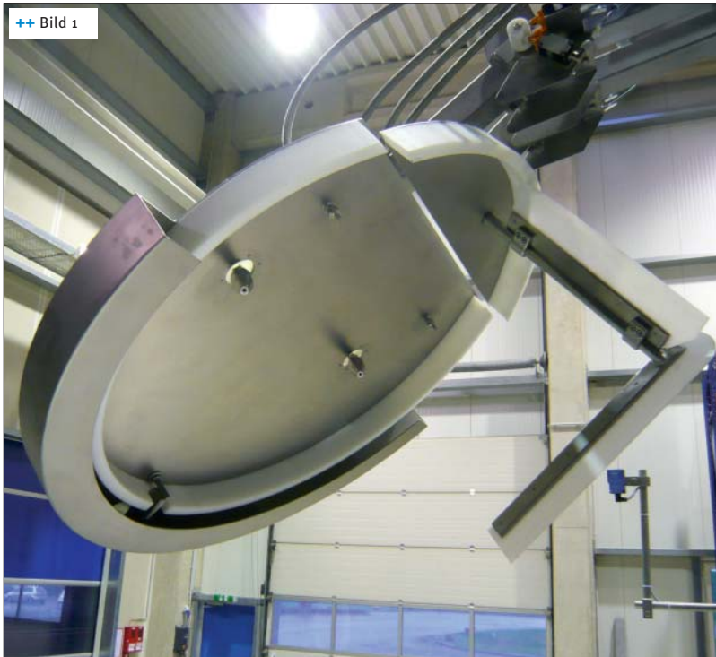
++ Bild 1 Im Deckel sitzen Hochdruckdüsen, die mit ihrer Kraft wegwaschen, was der Ausschäler (rechts) nicht bereits mitgenommen hat.
