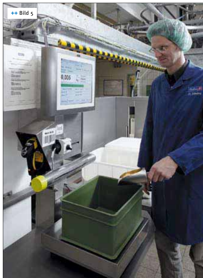
++ Bild 5 Rechnergeführtes Wiegen von Kleinstmengen
