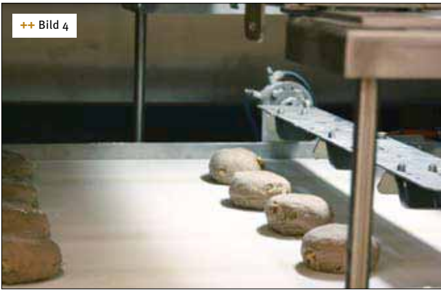
++ Bild 4 Die Teiglinge nach der Ausrichtung, die Ausrichtklappen ruhen oberhalb in Richtung der Teiglinge
