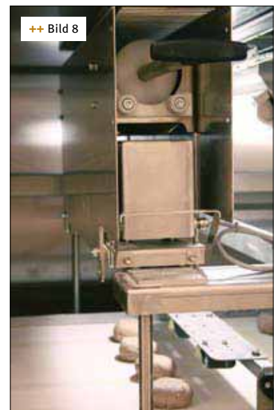
++ Bild 8 Der Stanzbrückenmehler lässt sich (auch automatisiert) im laufenden Betrieb nachfüllen
