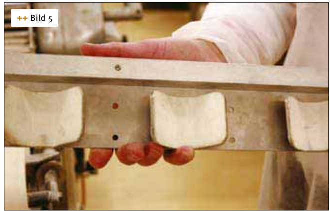
++ Bild 5 Die Ausrichtklappen sind an verschiedenen Stellen der Anlage zwischen den einzelnen Stationen eingebaut
