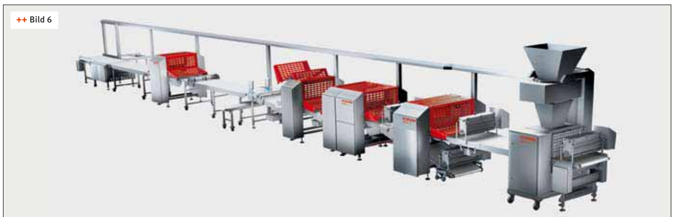
++ Bild 6 Die "Menes 1.0" Teigbandanlage für die Verarbeitung von besonders weichen und lang gegarten Teigen
