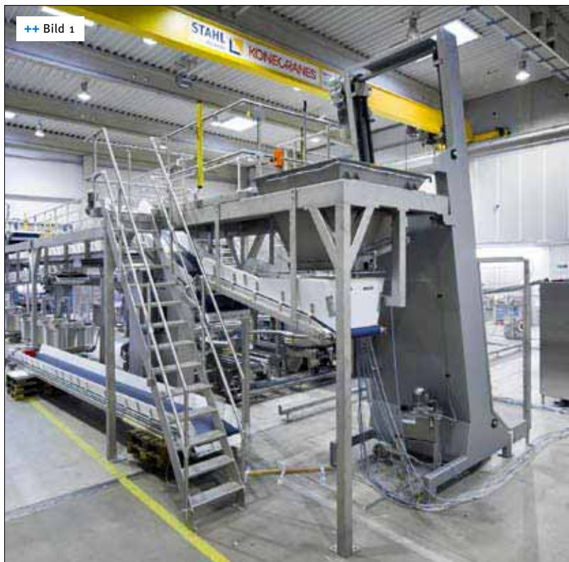
++ Bild 1 Ein Hebekipper entlädt die fertigen Teige auf ein Band, das die Teige zur Aufarbeitung befördert
