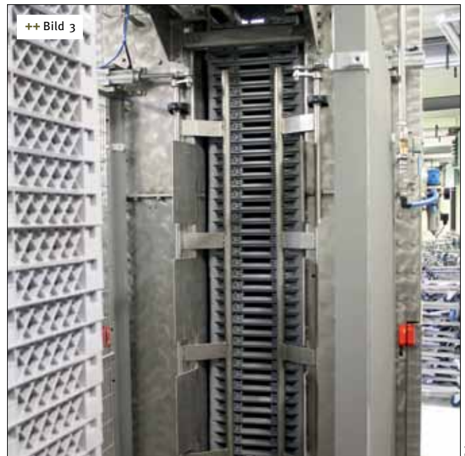
++ Bild 3 Die Körbe werden im Entstapler in eine Art Schleuse eingeführt, in der von oben beginnend die Körbe einzeln vom Stapel heruntergenommen werden
