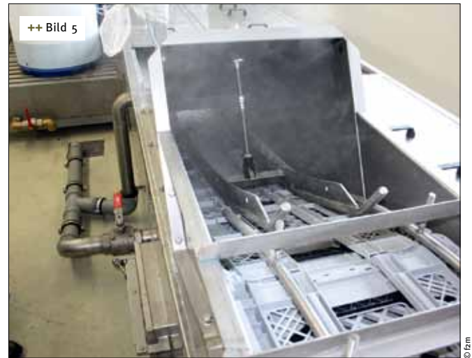
++ Bild 5 Die zusammengefalteten Körbe kommen komplett ins Tauchbad
