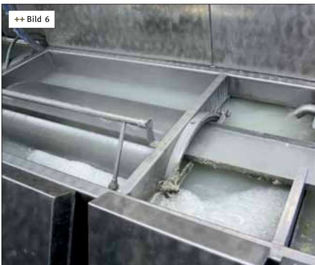
++ Bild 6 Die Reinigung der Waschlauge erfolgt über den seitlich angeordneten Trommelfilter
