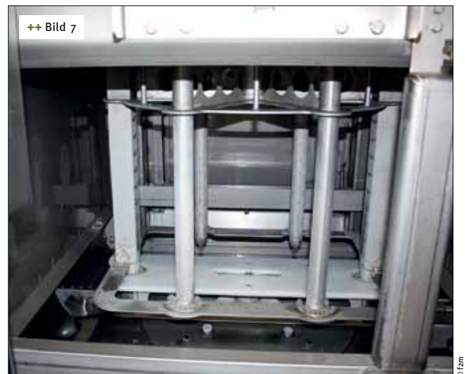
++ Bild 7 In der Trocknerzentrifuge gelangen die 10er-Korbbestapel auf die weiße Drehplatte und werden hier durch den Korb festgehalten und werden ca. 5 Sekunden lang gedreht
