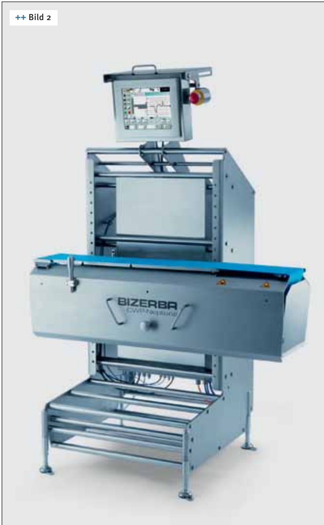
++ Bild 2 Bei der Kontrollwaage CWP Neptune wurde die Anzahl der Ecken, Kanten und Nischen auf ein Minimum reduziert, damit sich keine Verschmutzungen, Wasser und Rückstände von Reinigungsmitteln ansammeln können
