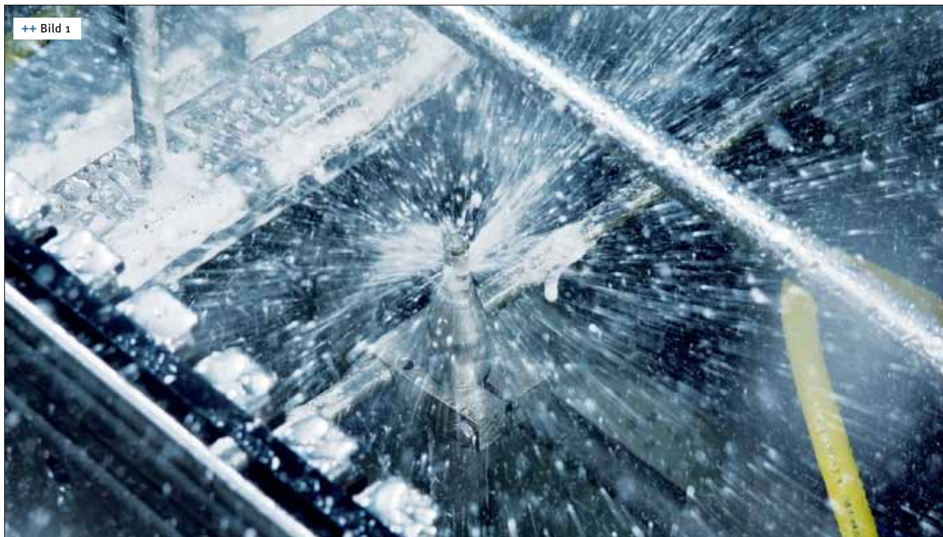
++ Bild 1 Das integrierte Cleaning-in-Place-System (CIP) sorgt für eine präzise, reproduzierbare Hygiene. Bei Standard-Thermoformmaschinen mit einer durchschnittlichen Maschinenlänge von 2,40–6 m werden ca. 1,3 m 3 Wasser pro Reinigungslauf verbraucht
