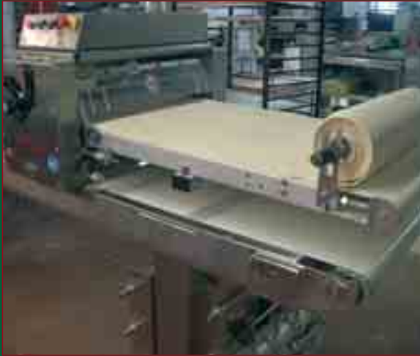
Der ausgerollte und aufgehaspelte Teig wird auf das Zuführband zum Aufsatzkalibrierer aufgelegt, der ihn dann auf die gewünschte Dicke bringt, stüpft und gleichzeitig den überstehenden Rand abschneidet.
