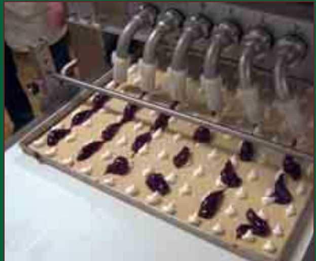
Die meist bei Feingebäckanlagen vorhandene Füllstation kann auch für das Aufbringen von Butterpunkten oder Fruchtfüllungen verwendet werden, was die Herstellung von Blechkuchen zusätzlich rationalisiert und gleichzeitig eine gleichmäßige Qualität sichert.
