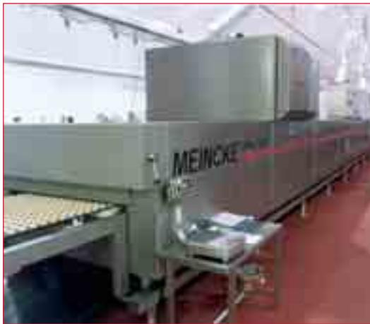
Die Heißluftöfen von Meincke gibt es bis zu einer Arbeitsbreite von 4 m und einer Länge von 80 m.
