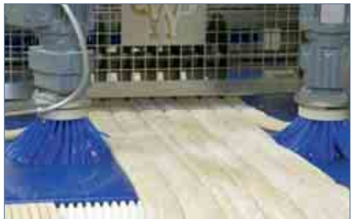
Die Umlaufgeschwindigkeit des gesamten Satelliten sowie die Drehgeschwindigkeit lassen sich separat steuern.
