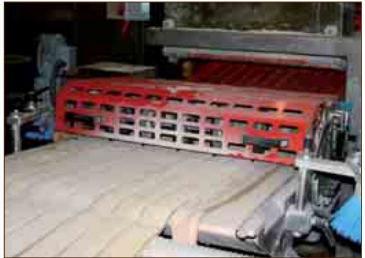
Dank der großen Arbeitsbreite laufen die eckigen Brötchen in bis zu 10 Reihen.
