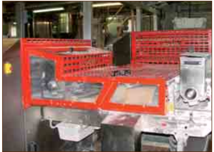
Der Wendepunkt der L-förmigen Anlage, hier wird der Teig abgetafelt.
