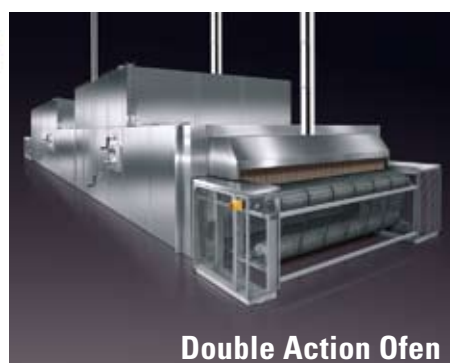
Anlage für Blätterteig-Produkte von 500 kg bis 1,5 t
