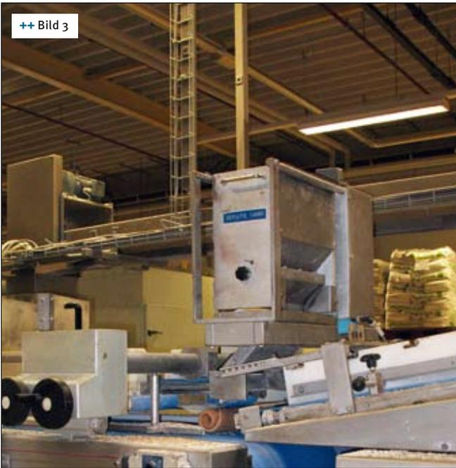
++ Bild 3 Ein Saatenstreuer sitzt über der Curling-Station, sodass die Saaten nicht von außen aufgestreut, sondern auch eingewickelt werden
