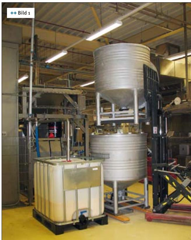
**++ Bild 1** Die Tanks mit dem speziellen Vorteig stehen bereit für die Produktion der Luxusorten im Brotsortiment von Deka. Die Anlage besteht aus einem Mixer und zwei Lagertanks aus Edelstahl und einer Schlauchpumpe zur schonenden Dosierung des Vorteiges aus dem unteren Tank. Der obere entleert sich in den unteren
