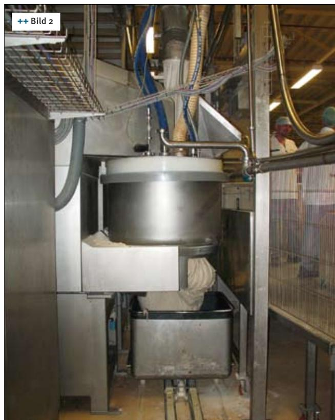
**++ Bild 2** Die beiden Diosna-Wendelknetter mit Mittenentleerung entlassen die Teige in schienengeführte Teigtrolleys. Von der Arbeitsbühne rechts werden sie mit CO<sub>2</sub>-Pellets zwecks Kühlung der Teige beschickt
