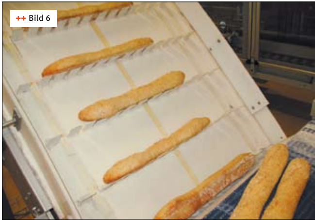
++ Bild 6 Transport der fertigen Baguettes in die Kühlung und in den Spiralfroster
