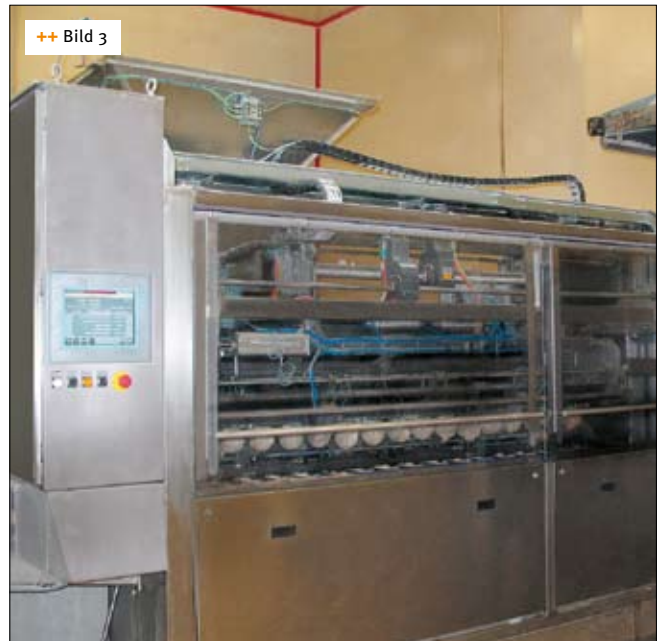
++ Bild 3 Der extrem schonend arbeitende TraDivider. Die Teige werden vom Hebekipper auf das Band rechts oben befördert und wandern von dort in den Trichter, der wie ein Schlitten über den Verwiegetrichter hin und her fährt und dabei vorportionierte Teigstücke abgibt
