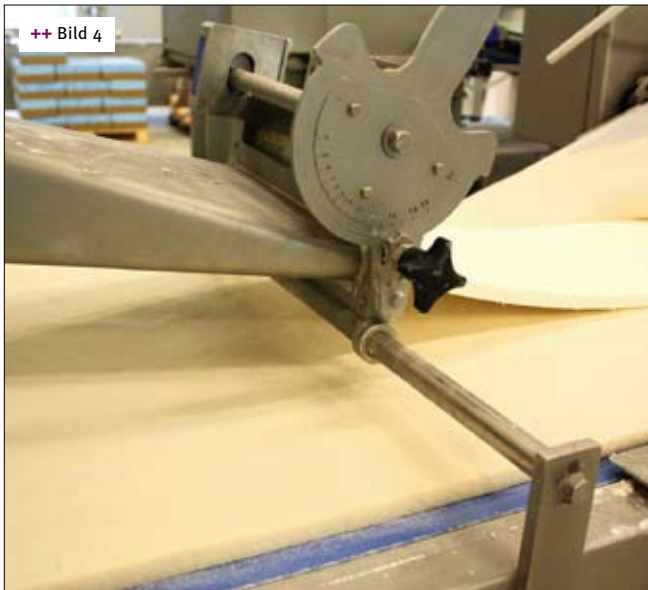
++ Bild 4 Die Düse der Fettpumpe ist variabel für die verschiedenen Rezepte
