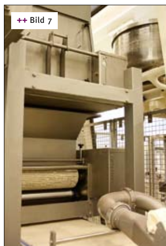
++ Bild 7 Über den Hebekipper gelangen insgesamt 1.200 kg Teig/Std. in die Linie
