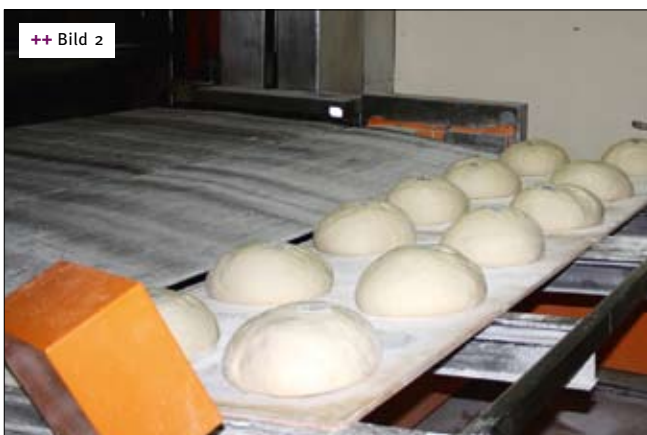
++ Bild 2+3 Das typische Weißbrot im Gewichtsbereich von 1.000–1.500 g wird sechsstufig im Netzbandofen gebacken und überwiegend geschnitten verkauft
