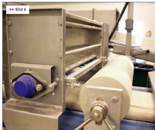
++ Bild 5+6 Nach dem Einarbeiten der Margarine in den Teig bemisst die Ausgabekontrolle das Teigband, um die Geschwindigkeit richtig einstellen zu können
